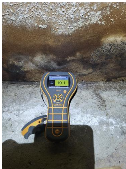
Rom under terreng (kjeller, underetasje, sokkeletasje) - [Fuktmålinger mot bad i kjeller i sidebygning]
