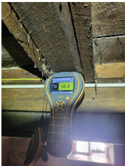
Rom under terreng (kjeller, underetasje, sokkeletasje) - [Fuktmålinger i sidebygning]
