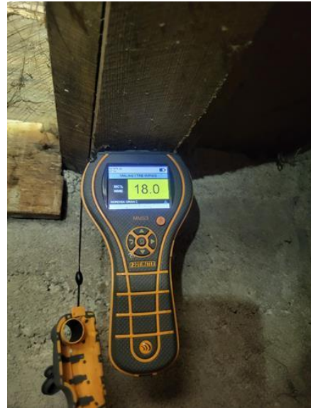
Rom under terreng (kjeller, underetasje, sokkeletasje) - [Fuktmålinger, Hovedhus]
